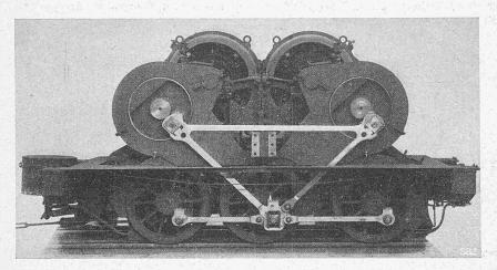
Abb. 3. Drehgestell der neuen Güterzug-Lokomotive der Bernina-Bahn.
