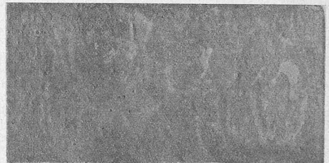
Abb. 4. Anstrichmasse bestehend aus 10 g Portlandzement, 10 g pulverisiertem Normalsand und 7 g 2%iger Lösung von K_2Cr_2O_7 . Gewicht des aufgetragenen Anstrichs in getrocknetem Zustand 0,75 g.
