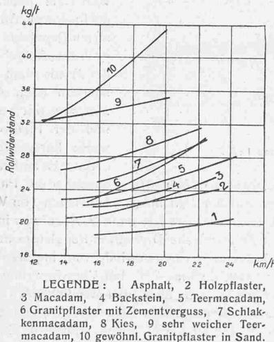
LEGENDE: 1 Asphalt, 2 Holzpflaster, 3 Macadam, 4 Backstein, 5 Termacadam, 6 Granitpflaster mit Zementverguss, 7 Schlakkenmacadam, 8 Kies, 9 sehr weicher Teermacadam, 10 gewöhnl. Granitpflaster in Sand.
