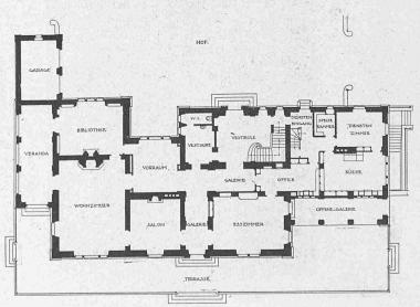
Masstab aller Zeichnungen 1:400. - Abb. 2. Erdgeschoss.
