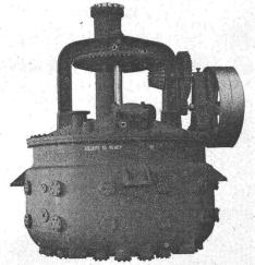
Mélangeur à double fond, diamètre 3500 mm
