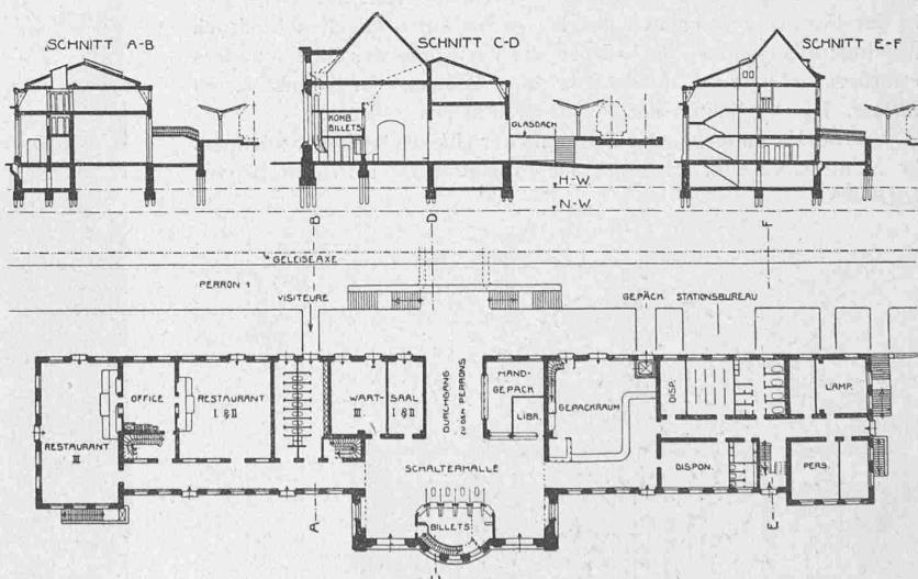
Abb. 2. Aufnahmegebäude des Bahnhofs; Erdgeschoss und Schnitte. — 1:1000.
