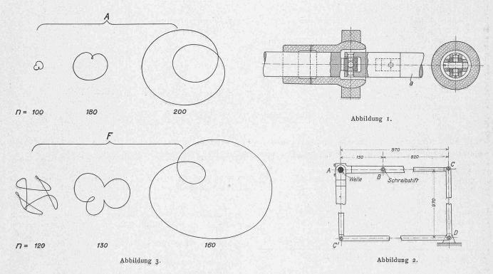
der Kraftübertragung entspricht den im Dampfturbinenbau noch viel angewandten losen Kupplungen. Dabei war die Welle a, die zu der die Antriebskraft liefernden kleinen Turbine führt, starr bis auf die Versuche M, N, wo zwischen
