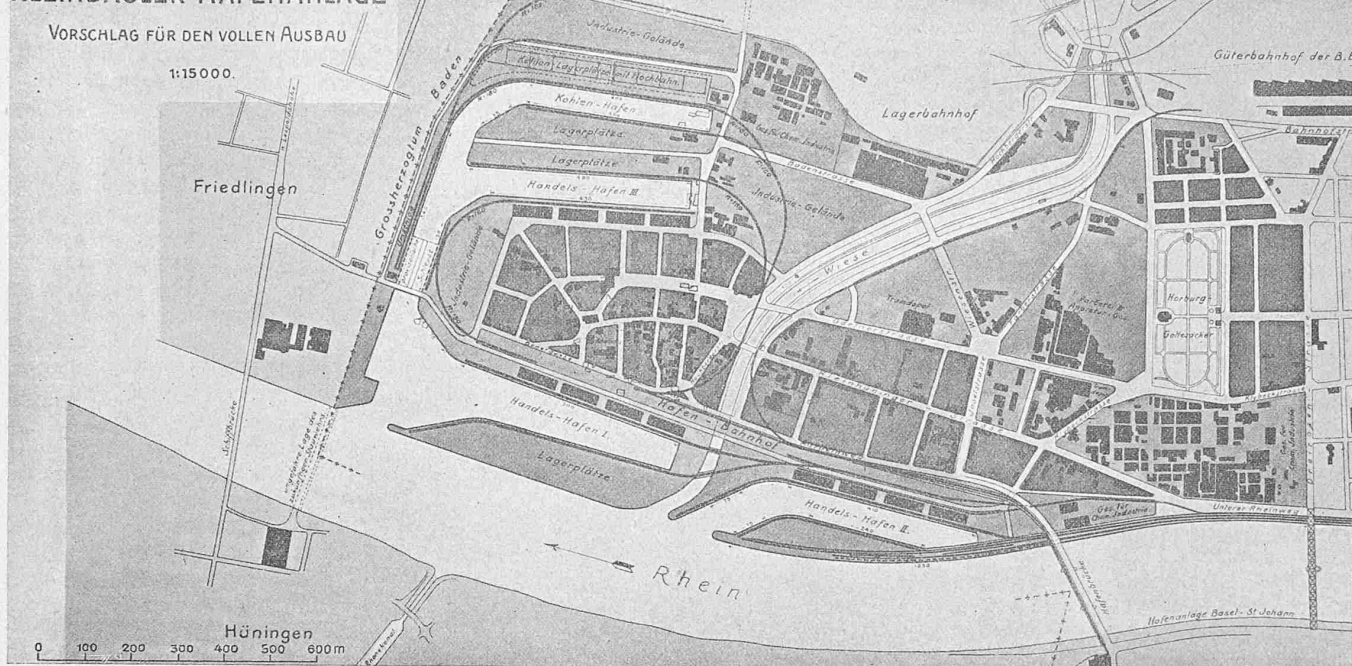
Abb. 5. Genereller Entwurf des Basler Ingenieur- und Architekten-Vereins zum Vollausbau des Rheinhafens in Kleinhünigen. — 1 : 15 000.
