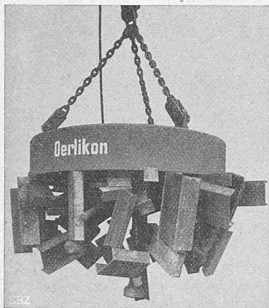
Abb. 2. Hebemagnet von 1500 mm Durchmesser.
