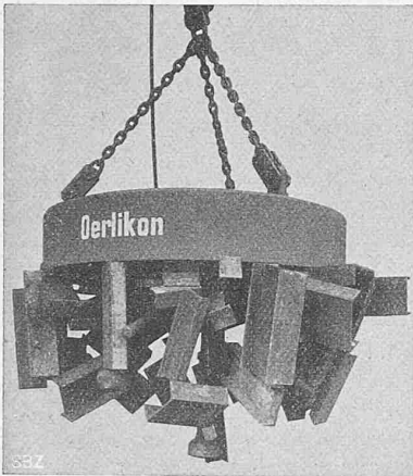
Abb. 2. Hebemagnet von 1500 mm Durchmesser.
