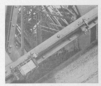
Abb. 4. Dehnungsmesser von Fränkel (an einem Bogenstab).
