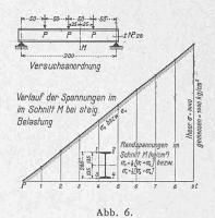
Gerade, entsprechend der theoretischen Annahme, dass die Spannungen den Belastungen proportional sind. Die gemessene Höchstspannung von 1440 kg/cm² ist gleich der theoretischen. (Forts. folgt.
