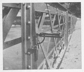
Abb. 1. Messung der Winkeländerung mittels Klinometer am Ouerrahmen-Pfosten einer offenen Brücke.
