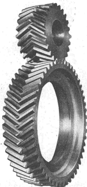
Figur 5. Pfeilradgetriebe der Jungfraubahn. Gehobelte Maag-Verzahnung.
