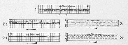
Abb. 29. Frequenzmesser- und Tachographen-Anfnahmen im Kraftwerk Augst der Stadt Basel. Verminderung der Geschwindigkeits-Schwankungen durch Verbesserung der nachgiebigen Rückführung.
