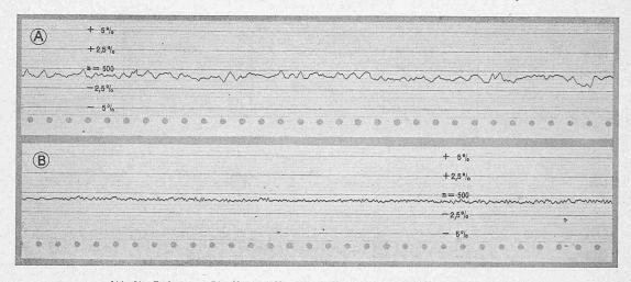
Abb. 31. Tachogramme\_der Vergleich-Versuche im Kraftwerk Augst, auf normale Netzbelastung.
