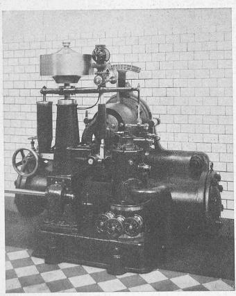
Abb. 26. Ursprünglicher Turbinenregulator im Kraftwerk Augst.
