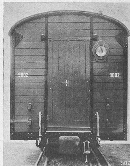
Abb. 2. Stirnwand ohne Plattform mit Doppeltüre des Hülfswagens der Rhätischen Bahn.
