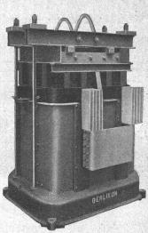
Einphasenwechselstrom-Transformator mit künstlicher Luftkühlung. Leistung 1500 kVA, 4000 Volt primär, 100 Volt und 15000 Ampère sekundär, 50 Perioden.
