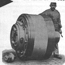
Benn Kupplung Nr. 12 für 600 PS gellefert in eine Zementfabrik.
