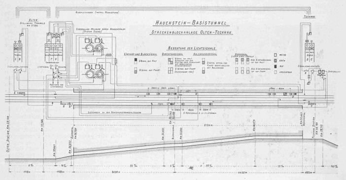
Abb. 1. Längenprofil des Hauenstein-Basistunnel mit schematischer Darstellung der Streckenblockanlage Olten-Tecknau.
