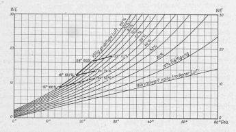
Wäre z. B. die Temperatur des Raumes (trockenes Thermometer) 20° C und die relative Luftfeuchtigkeit 20°/<sub>0</sub>, und geht man im Diagramm von dem Punkte, der diesen Zustand darstellt, auf einer Parallelen zur Abszissenaxe (Linie konstanten Wärmeinhaltes) nach links, bis zur Kurve für vollgesättigte Luft, so schneidet man diese Kurve bei einer Temperatur von 9° C. Bis zu dieser Grenze wird sich das feuchte Thermometer abkühlen.
