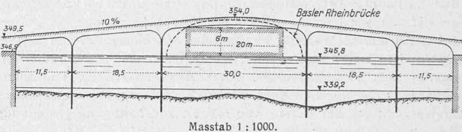
Basler Brückenprofils von maximal 28 m Spannweite, das nur auf etwa 20 m die 6 m Höhe aufweist. Die Brücken zwischen Schaffhausen und Stein a. Rh. weisen noch wesentlich kleinere Öffnungen auf, dazu wie in Basel eine z. T. sehr starke Strömung. Im Gegensatz hierzu käme der Rheinsteg in Eglisau in die Strecke mit kaum mehr spürbarer Wassergeschwindigkeit zu stehen, wo die geradezu prohibitiv wirkende Profilforderung einfach unverständlich ist.
