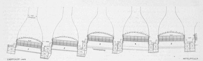
Abb. 5. Hochwasser-Ueberlauf am Pantano de La Pena; Grundriss der Einläufe Nr. 1 bis 5. — Masstab 1:600.
