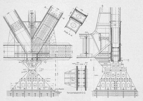
Abb. 71. Auflagerstuhl auf dem Mittelpfeiler der Sciotoville-Brücke über den Ohio. - Masstab 1:100.
