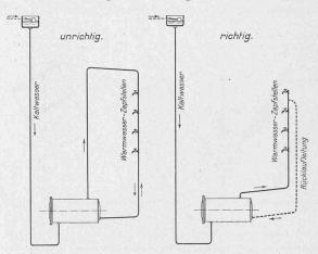
Abb. 2. Schemata von Warmwasser-Verteilungsanlagen.
