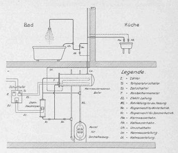
Abb. 1. Elektrische Warmwasserbereitungsanlage.
