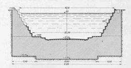
Abb. 23. Querschnitt des neuen Docks. — 1:800.
