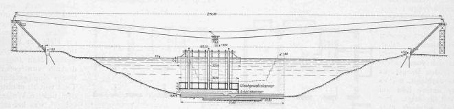
Abb. 24. Querschnitt durch die Baugrube, Längsschnitt durch den beweglichen Caisson. — Masstab I: 1200.
