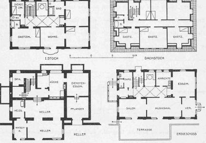
Abb. 4 bis 7. Grundrisse des umgebauten "Schlössli" in Zollikon. — 1:400.
