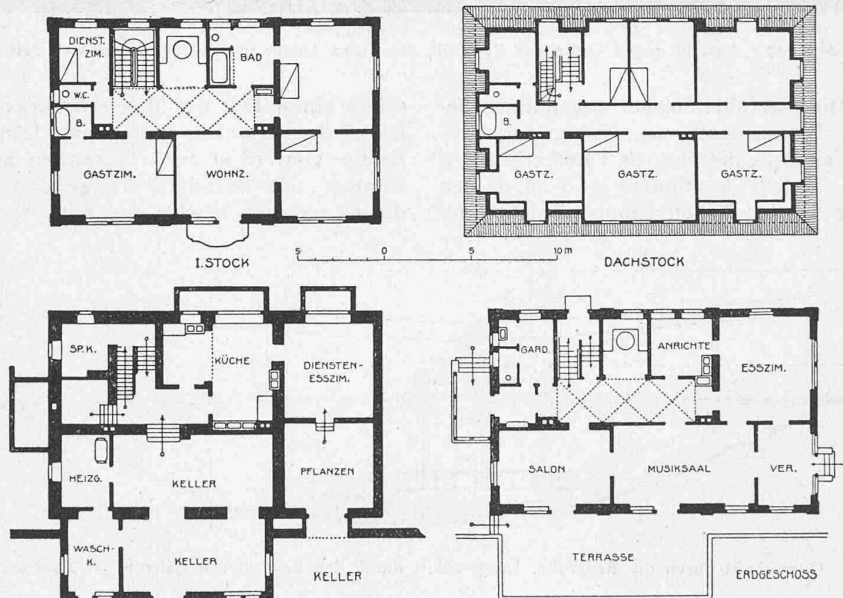
Abb. 4 bis 7. Grundrisse des umgebauten „Schlössli“ in Zollikon. — 1 : 400.
