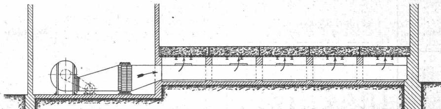
Trockenanlage mit Sendric-Apparat und Sulzer-Zentrifugal-Ventilator.
