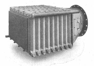
Sendric-Apparat zum Kühlen von Gasen mittelst kalten Wassers. (Linke Haube abgenommen).
