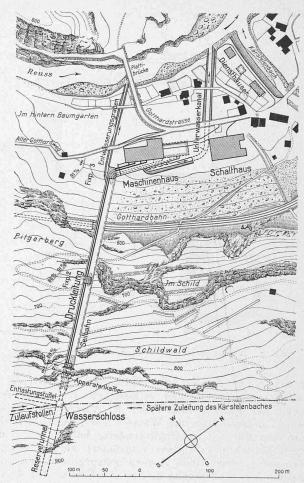
Abb. 10. Wasserschloss, Druckleitung und Kraftwerk.
