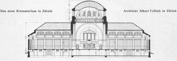
Abb. 6. Längsschnitt durch die geschlossenen Urnenhallen und den Kuppelraum, - 1:400.
