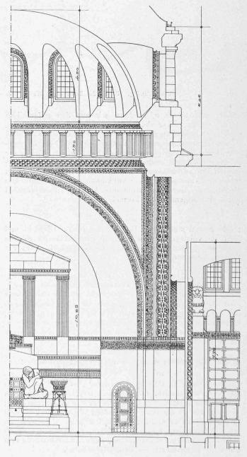
Abb. 7. Detail-Schnitt des Kuppelraums. - 1:100.
