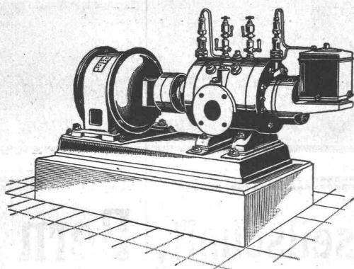
Direkte Kupplung mit Elektromotoren oder Riemenbetrieb.
