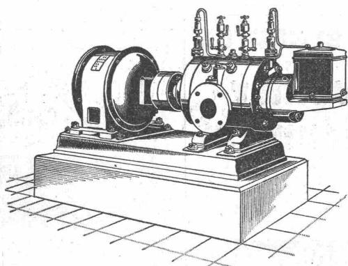
Direkte Kupplung mit Elektromotoren oder Riemenbetrieb.
