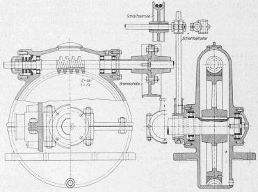
Abb. 46. Schnecke zur Aufzugswinde in Abb. 45. — 1:10.
