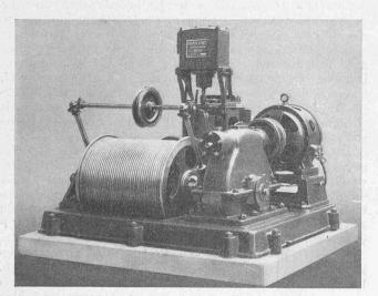
Abb. 45. Ansicht der Aufzugswinde im nördlichen Aussichtsturm.
