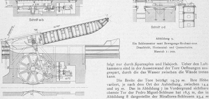
Schnitt c-d Abbildung 9. Ein Schleusentor samt Bewegungs-Mechanismus. Draufsicht, Horizontal- und Querschnitte. Masstab I: 200.
