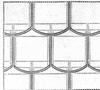
**Verwendung:** Sie dient als Unterlage für Biberschwanzziegel-Dächer anstelle der früher verwendeten 3 Stück Holzschindeln und überdauert diese letztern wenigstens zehnmal.
