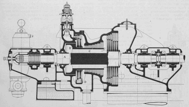
Abb. 1. Kombinierte Ueberdruck-Dampsturbine für 9000 PS bei 3000 Uml/min. — Brown, Boveri & Cie., Baden, Schweiz.
