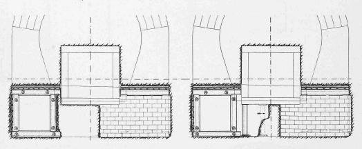
Abb. 18. Fertiger Unterstollen links. - 1:150. - Abb. 19. Ausbruch unter den Eisenrahmen.
