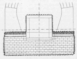
Abb. 22 und 23. Untermauerung der Eisenrahmen und Vollendung des Sohlenblocks. — 1:150.
