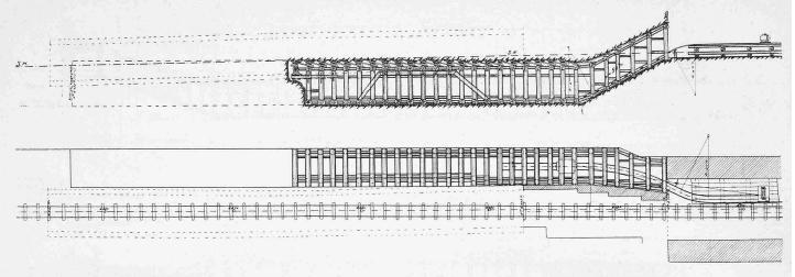
Abb. 14 und 15. Grundriss und Längsschnitt durch Unterstollen links (westlich); Ausbruch und Zimmerung. — Masstab 1:300.
