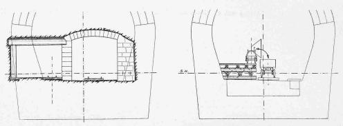
Abb. 16 und 17. Stollen-Abzweigung und Umladerampe von 50 auf 80 cm Spur. - 1:150.
