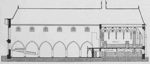
Abb. 3. Längsschnitt der Welschen Kirche in Bern mit umgebautem Chor. — 1:500. — Abb. 4 (rechts). Querschnitt.
