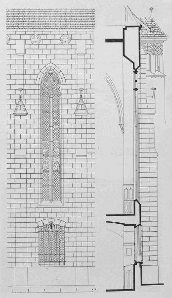
Abb. 11. Detail einer Chorfenster-Axe nach Ausführung.
