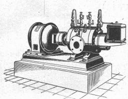
Direkte Kupplung mit Elektromotoren oder Riemenbetrieb.
