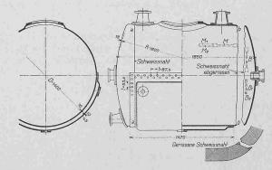
Abb. 1. Explodiertes Dampfgefäss. — Masstab 1:40.
