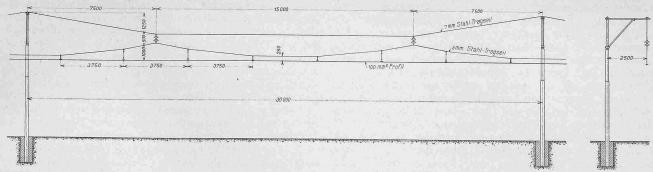
Abb. 79. Vollbahn-Kontaktleitung mit Vielfachaufhängung und doppelter Isolierung. — Masstab 1:200.
