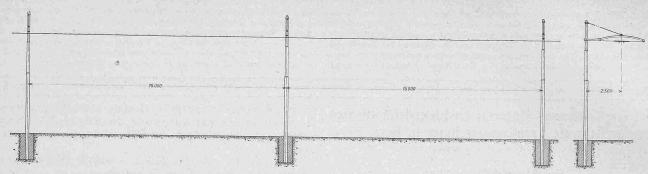
Abb. 78. Strassenbahn-Kontaktleitung mit Einfach-Aufhängung und doppelter Isolierung. — Masstab 1:200.
