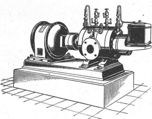
Direkte Kupplung mit Elektromotoren oder Riemenbetrieb.
