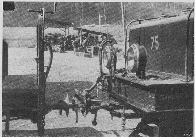
Abb. 9. Verbindung mit Uebergangs-Kupplungsglied (vergl. Abb. 7) zwischen Trichter-Kupplung und automat. Kupplung.
