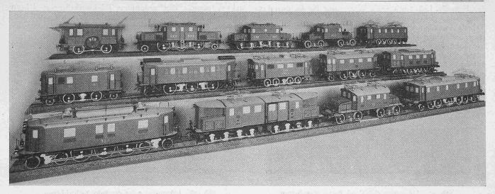
Abb. 22. Modellgruppe der wichtigsten von Brown, Boveri & Cie. von 1898 bis 1914 gebauten elektrischen Lokomotiven.
