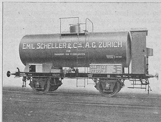
Abb. 61. Zisternenwagen; Tara 11,15 t, Ladegewicht 16,15 t. Beide Wagen erbaut von der Schweizerischen Wagons-Fabrik Schlieren.
