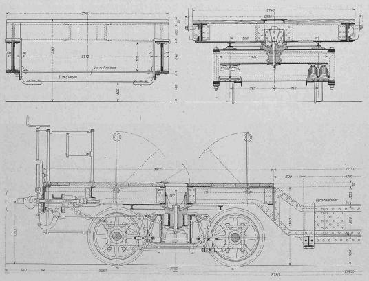
Abb. 53 und 54. Längs- und Querschnitte zum Spezialgüterwagen Serie O1 der S. B. B. - Masstab 1:40.
