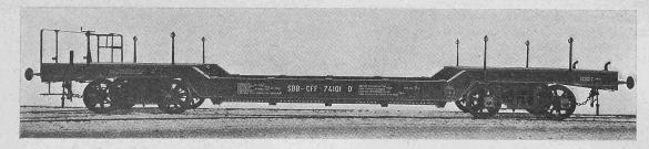
Abb. 52. Spezialwagen Serie O1 der S. B. B., gebaut von der Wagonsfabrik Schlieren. - Tara 22,7 t, Ladegewicht 35 t.
