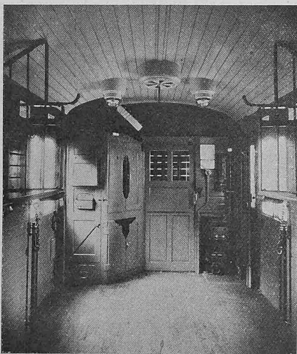
Abb. 48. Bahnpostwagen für Meterspur; Paketraum gegen die Wagenmitte gesehen.
