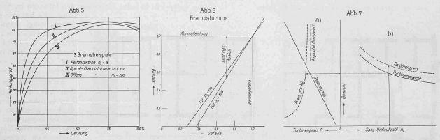
vermindertem Gefälle, aber konstanter Umlaufzahl. Das Verhalten von Turbinen mit verschiedenen spezifischen Umlaufzahlen in dieser Hinsicht zeigt Abbildung 6. Daraus ist ersichtlich, dass für schnellaufende Turbinen grössere Hochwasser-Reserven aufzustellen sind, als für langsamer laufende.
