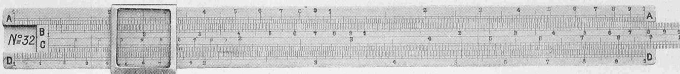
bestimmt man den Querschnitt der gleich starken Holzsäule (vergl. Abb. 30): 6 auf Skala *B* unter 31,2 auf *A* ergibt unter dem 1 auf *C* die Seitenlänge  $a$  auf Skala *D* mit 2,28 dm. Der mittlere Durchmesser der Guss-Säule ist 1,9 mal kleiner, also  $d = 1,2$  dm, die Wandstärke = 0,12 dm oder 12 mm.
