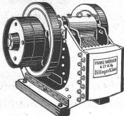
Backenbrecher, unzerbrechlich mit Gehäuse aus Dillinger Panzerstahlplatten
