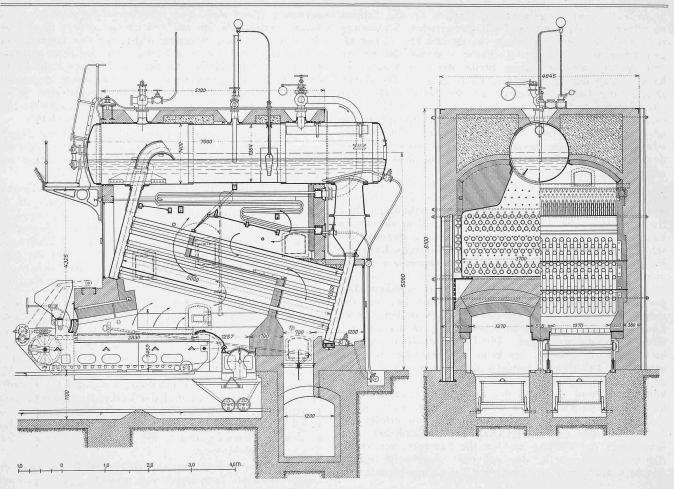
Abb. 3. Zweikammer-Wasserrohrkessel von 270 m² Heizfläche der A.-G. der Maschinenfabriken von Escher Wyss & Cie. in Zürich. - Masstab 1:80.
