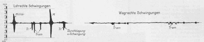
Abb. 24. Kombinierte Aufzeichnung der Schwingungen und Durchbiegungen mit Rabut-Apparat.
