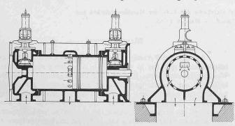
Abb. 1. Schema des Zylinders einer Gleichstrom-Dampfmaschine.
