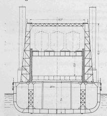
Breite und 7,4 m Tiefe und weist bei Vollladung einen Tiefgang von 4,6 m auf. Das Hauptdeck, dessen Lage durch zwanzig vertikale Spindeln um 5,5 m in der Höhe verändert werden kann, hat 83 m Länge und 13 m Breite, trägt drei Geleise und ist an beiden Enden mit Klappbrücken von 8,5 m Länge versehen. Neben den zum Antrieb der beiden Schrauben dienenden Dampfmaschi-
